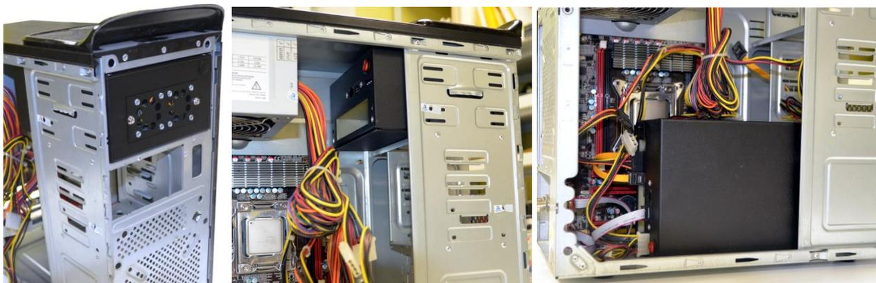
8. Установите на свободное место дополнительные блоки стирания. Соедините Главный блок с Дополнительными кабелем. Кабель подключается к разъему P2 главного устройства и соответствующему любому разъему на дополнительном блоке. В качестве кабеля может использоваться стандартный патч-корд RJ45 (витая пара, 8 проводов). 3-й блок стирания подключается к свободному разъему 2-го.
