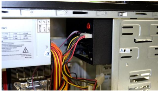
Подключите питание от системного блока питания к дополнительным блокам стирания. Функционирование дополнительных блоков осуществляется по кабелю от главного блока. От разъемов питания работает только система охлаждения диска в камере устройства.
