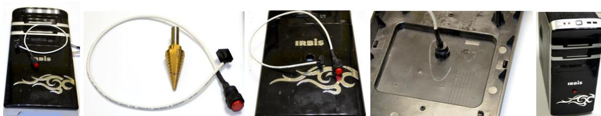
Просверлите в удобном с вашей точки зрения месте отверстие диаметр 15мм (ДЛЯ ЭТОГО УДОБНО ВОСПОЛЬЗОВАТЬСЯ СТУПЕНЧАТЫМ СВЕРЛОМ). Вставьте с лицевой стороны индикатор в отверстие до упора в корпус и закрепите гайкой. Внутренняя проводная кнопка подключается к устройству через разъем P1.
