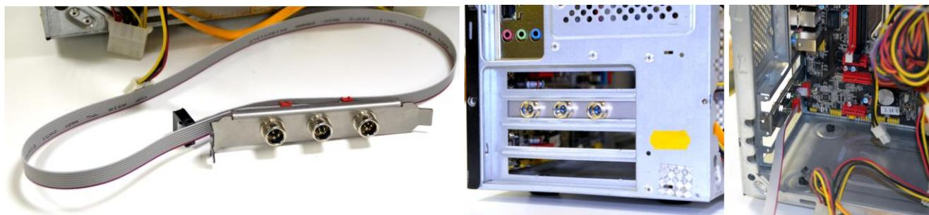
Через нее к устройству удобно подключаются блок радиоканала, внешняя проводная кнопка, блок контроля доступа.
