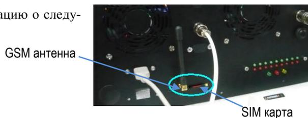
Контроллер устанавливается в зоне радиовидимости GSM сети, питание по интерфейсному кабелю.
